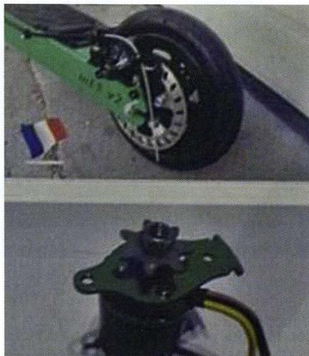
Oben: Hinterradantrieb, unten: der verwendete Elektromotor.
